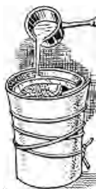
Рис. 34. а) способ инкрустирования деревянного предмета; б) курительная трубка канза . Дерево, инкрустация оловом. Колл. Омского историко-краеведческого музея 151
